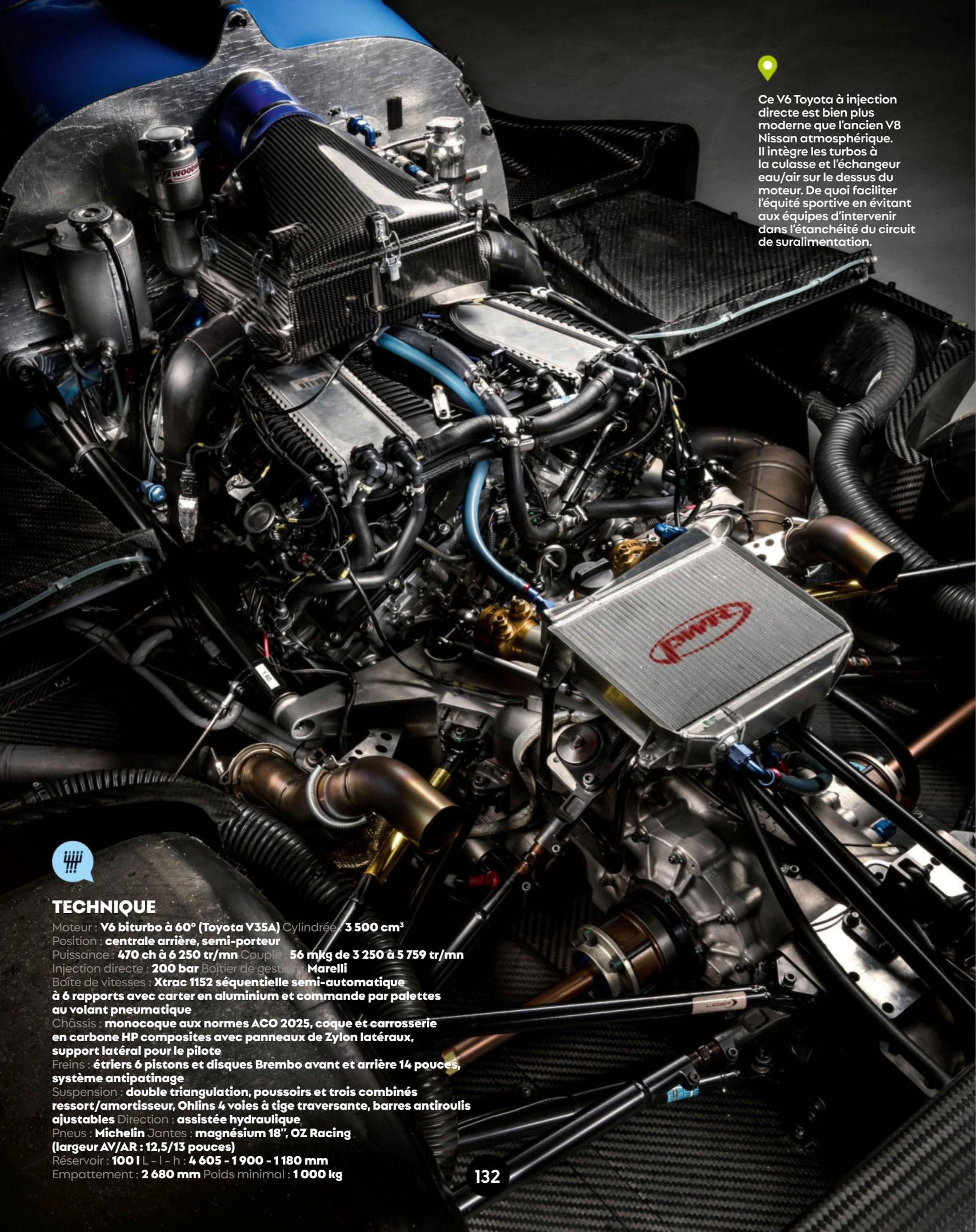
Ce V6 Toyota à injection directe est bien plus moderne que l'ancien V8 Nissan atmosphérique. Il intègre les turbos à la culasse et l'échangeur eau/air sur le dessus du moteur. De quoi faciliter l'équité sportive en évitant aux équipes d'intervenir dans l'étanchéité du circuit de suralimentation.
