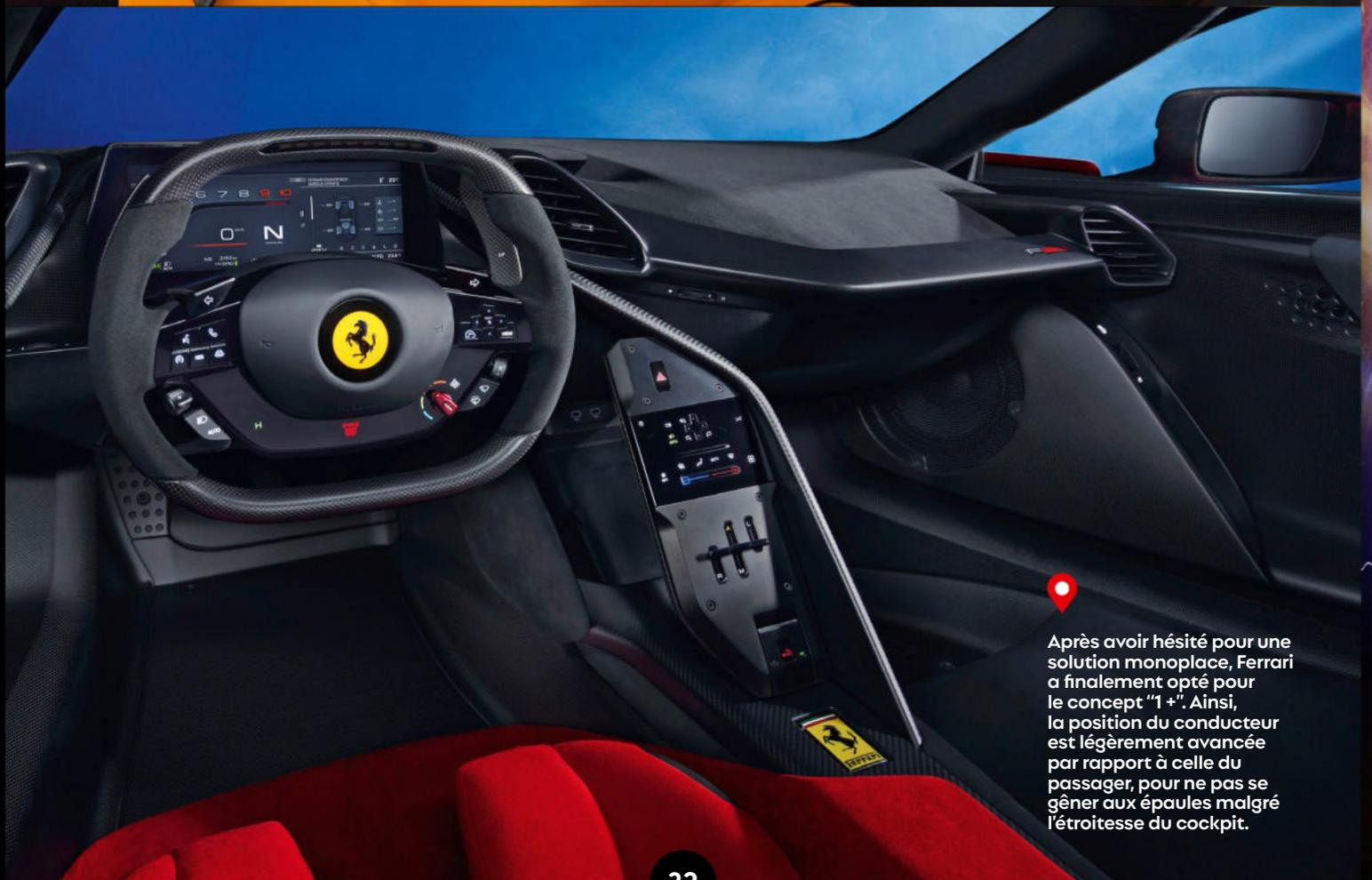
Après avoir hésité pour une solution monoplace, Ferrari a finalement opté pour le concept "1+". Ainsi, la position du conducteur est légèrement avancée par rapport à celle du passager, pour ne pas se gêner aux épaules malgré l'étroitesse du cockpit.
